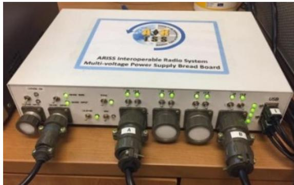
El IORS consta de un transceptor JVCKenwood TM-D710GA modificado a medida, una fuente de alimentación multivoltaje desarrollada por AMSAT y cables de interconexión. Una vez en la estación espacial, los IORS se guardarán para su posterior instalación.
